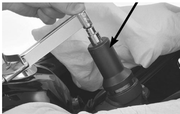
GUIA CAPA DA PORCA COLUNA DE DIREÇÃO E ARRUELA MESA SUPERIOR
