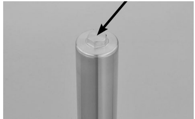
PARAFUSO SUPERIOR DO GARFO DA SUSPENSÃO
